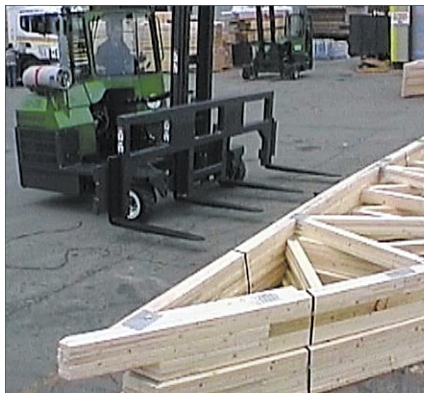
Čtyřramenné vidle s rychlým nasazením usnadňují manipulaci s velmi dlouhými náklady.
